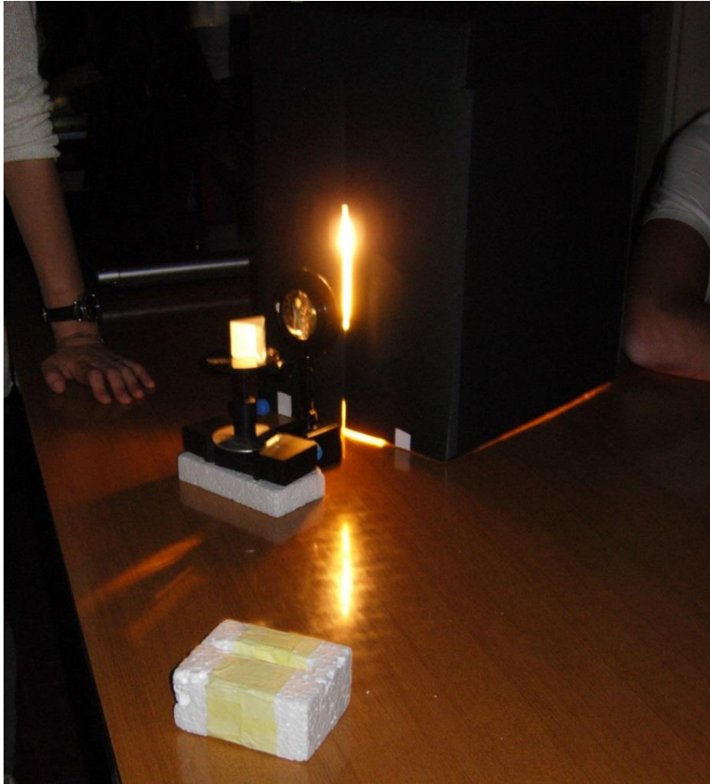
Scatola di polistirolo, lampadina 60 W, lente convergente, prisma
