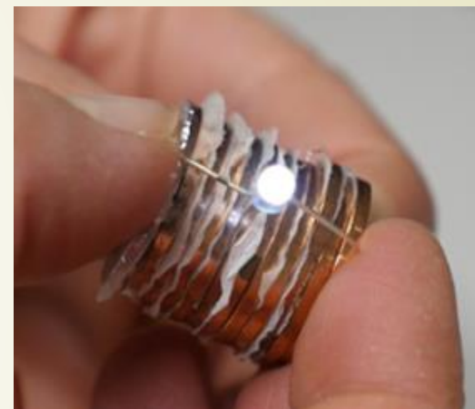
Pila di Volta costruita dagli studenti
