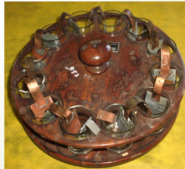
Pendolo di Huygens (sopra) e pila a corona di tazza (sotto)
