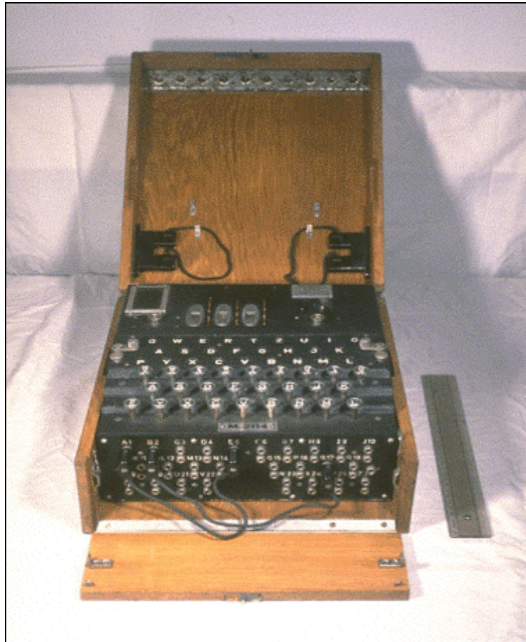
Figura 10. Macchina Enigma con visibile il pannello a prese multiple.
